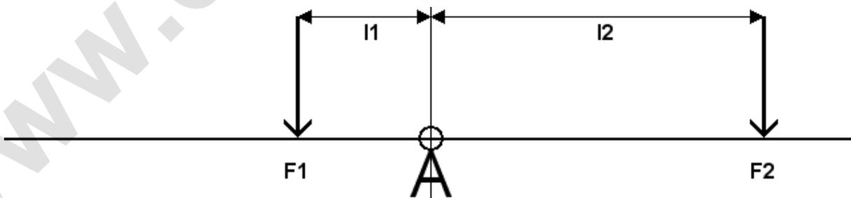
Aufgaben zum Hebelgesetz am zweiseitigem Hebel. Berechne die Länge des Hebels  $l_2$  und runde auf 2 Stellen nach dem Komma.
