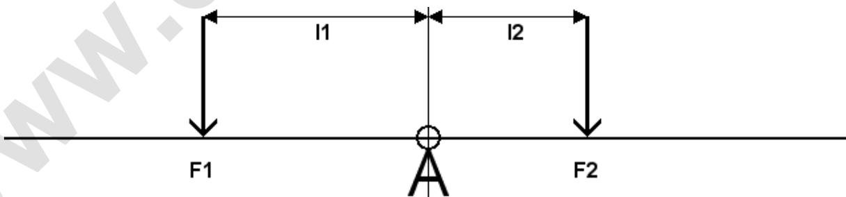
Aufgaben zum Hebelgesetz am zweiseitigem Hebel. Berechne die Länge des Hebels  $l_1$  und runde auf 2 Stellen nach dem Komma.
