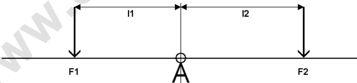
Aufgaben zum Hebelgesetz am zweiseitigem Hebel. Berechne F2 und runde auf 2 Stellen nach dem Komma.
