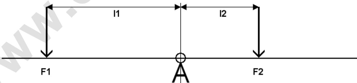
Aufgaben zum Hebelgesetz am zweiseitigem Hebel. Berechne F1 und runde auf 2 Stellen nach dem Komma.
