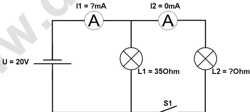
Berechne U, I, R und P im verzweigten Stromkreis (Parallelschaltung).
