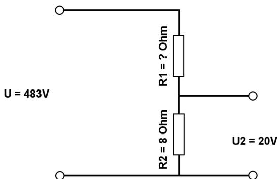
Berechne mit der Spannungsteilerregel die fehlenden Werte.
