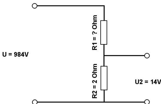
Berechne mit der Spannungsteilerregel die fehlenden Werte.
