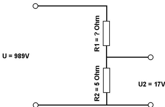
Berechne mit der Spannungsteilerregel die fehlenden Werte.
