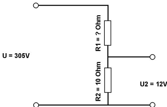
Berechne mit der Spannungsteilerregel die fehlenden Werte.
