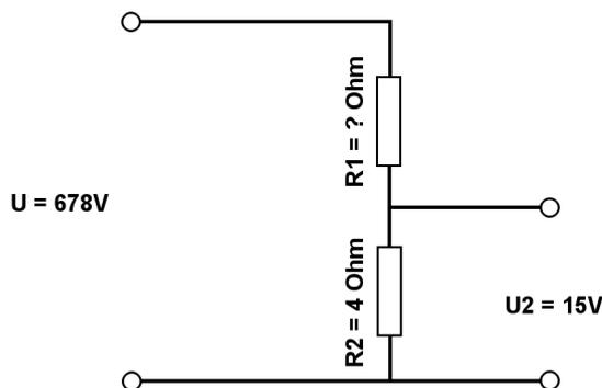
Berechne mit der Spannungsteilerregel die fehlenden Werte.
