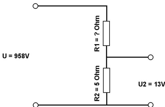
Berechne mit der Spannungsteilerregel die fehlenden Werte.
