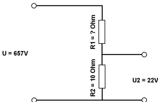
Berechne mit der Spannungsteilerregel die fehlenden Werte.
