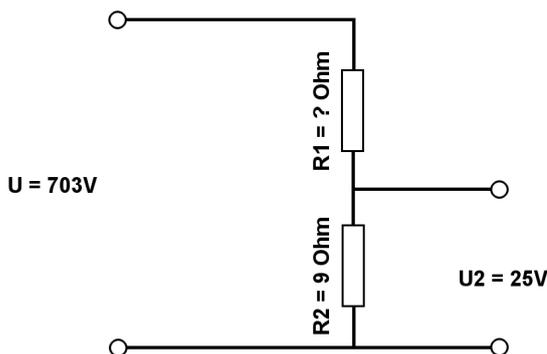
Berechne mit der Spannungsteilerregel die fehlenden Werte.
