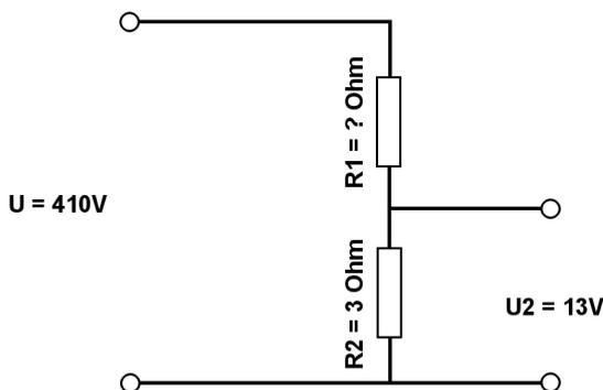
Berechne mit der Spannungsteilerregel die fehlenden Werte.
