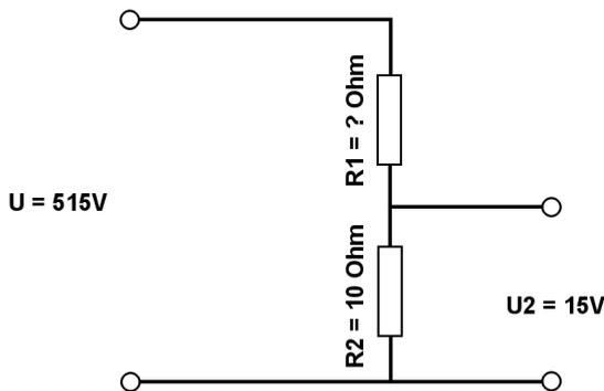
Berechne mit der Spannungsteilerregel die fehlenden Werte.
