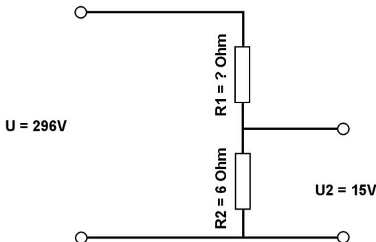
Berechne mit der Spannungsteilerregel die fehlenden Werte.
