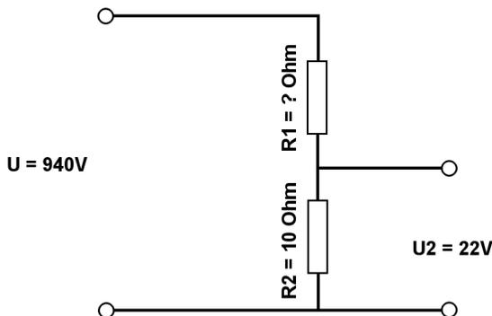
Berechne mit der Spannungsteilerregel die fehlenden Werte.
