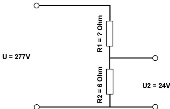
Berechne mit der Spannungsteilerregel die fehlenden Werte.
