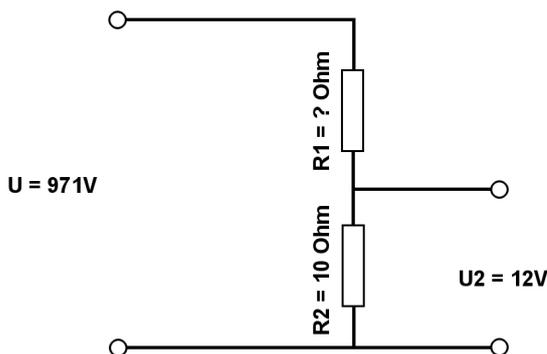
Berechne mit der Spannungsteilerregel die fehlenden Werte.
