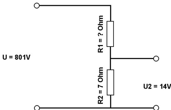
Berechne mit der Spannungsteilerregel die fehlenden Werte.
