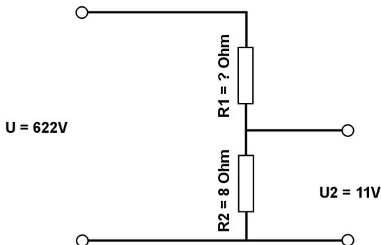
Berechne mit der Spannungsteilerregel die fehlenden Werte.
