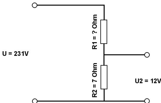
Berechne mit der Spannungsteilerregel die fehlenden Werte.
