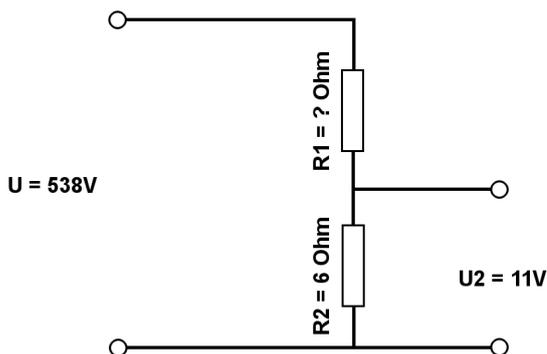
Berechne mit der Spannungsteilerregel die fehlenden Werte.
