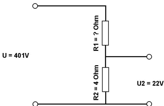
Berechne mit der Spannungsteilerregel die fehlenden Werte.
