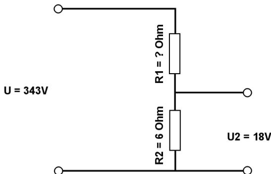
Berechne mit der Spannungsteilerregel die fehlenden Werte.
