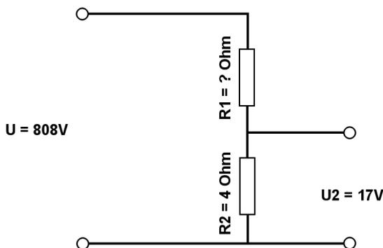
Berechne mit der Spannungsteilerregel die fehlenden Werte.
