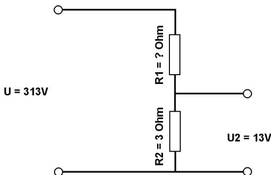
Berechne mit der Spannungsteilerregel die fehlenden Werte.
