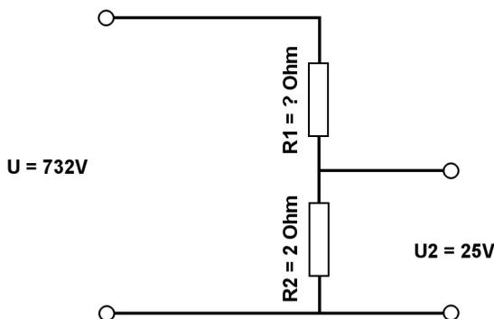
Berechne mit der Spannungsteilerregel die fehlenden Werte.
