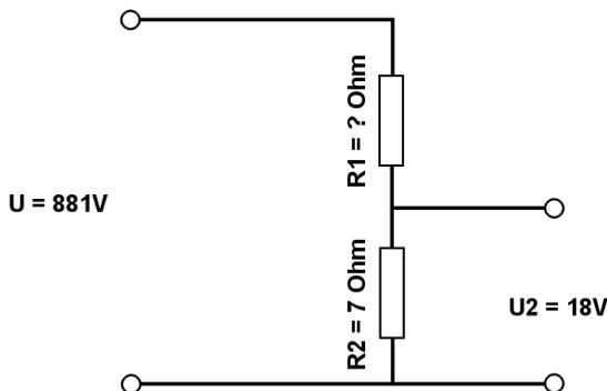
Berechne mit der Spannungsteilerregel die fehlenden Werte.
