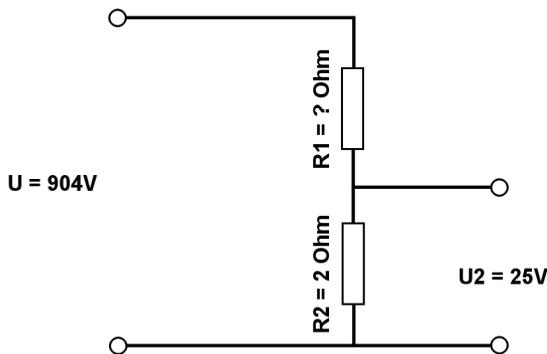
Berechne mit der Spannungsteilerregel die fehlenden Werte.
