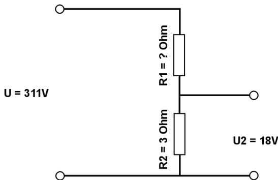
Berechne mit der Spannungsteilerregel die fehlenden Werte.
