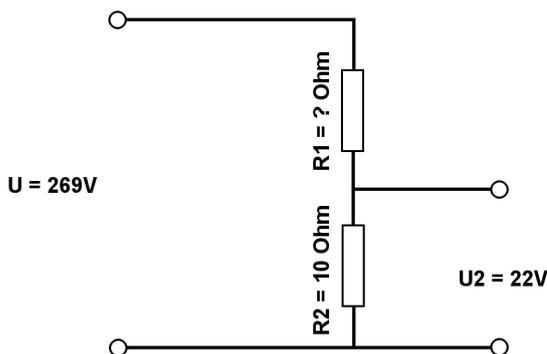
Berechne mit der Spannungsteilerregel die fehlenden Werte.
