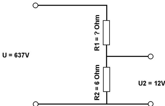
Berechne mit der Spannungsteilerregel die fehlenden Werte.
