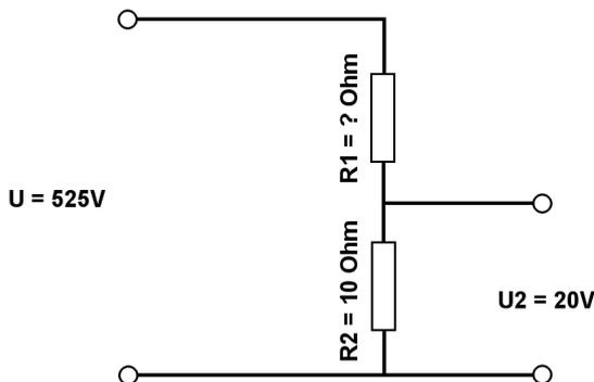
Berechne mit der Spannungsteilerregel die fehlenden Werte.
