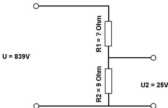
Berechne mit der Spannungsteilerregel die fehlenden Werte.
