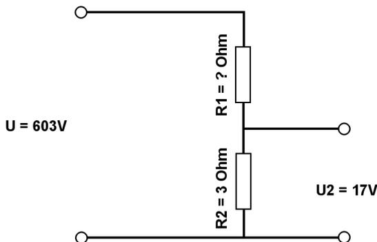
Berechne mit der Spannungsteilerregel die fehlenden Werte.
