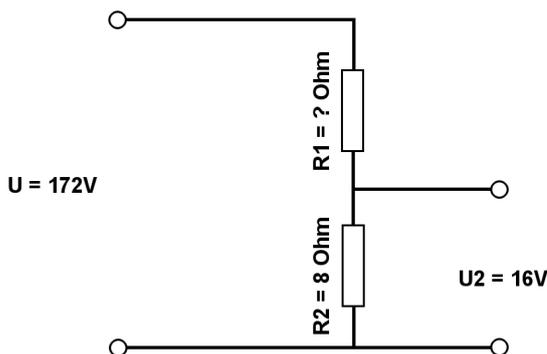
Berechne mit der Spannungsteilerregel die fehlenden Werte.
