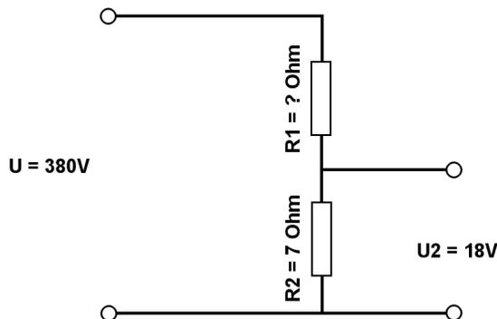
Berechne mit der Spannungsteilerregel die fehlenden Werte.
