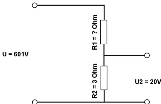
Berechne mit der Spannungsteilerregel die fehlenden Werte.
