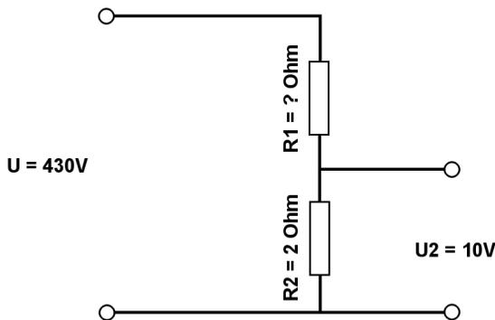
Berechne mit der Spannungsteilerregel die fehlenden Werte.
