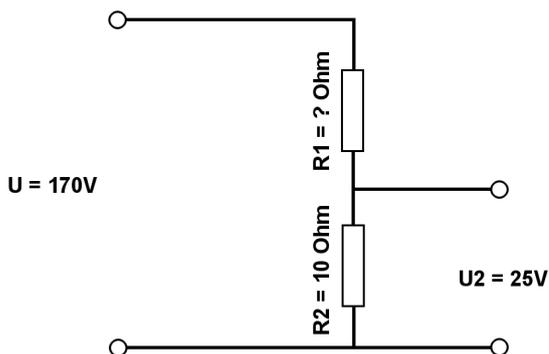
Berechne mit der Spannungsteilerregel die fehlenden Werte.
