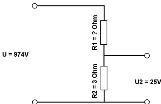
Berechne mit der Spannungsteilerregel die fehlenden Werte.
