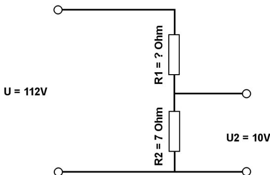
Berechne mit der Spannungsteilerregel die fehlenden Werte.
