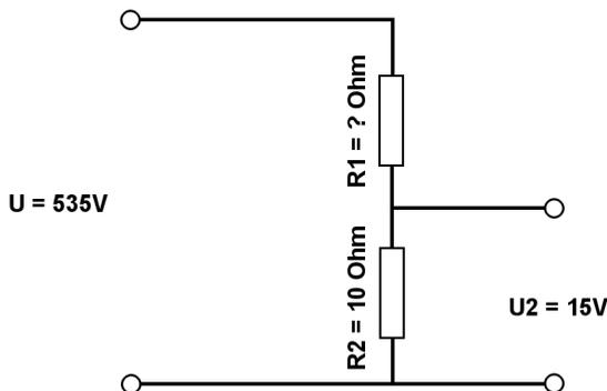
Berechne mit der Spannungsteilerregel die fehlenden Werte.
