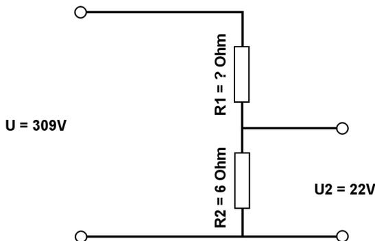
Berechne mit der Spannungsteilerregel die fehlenden Werte.
