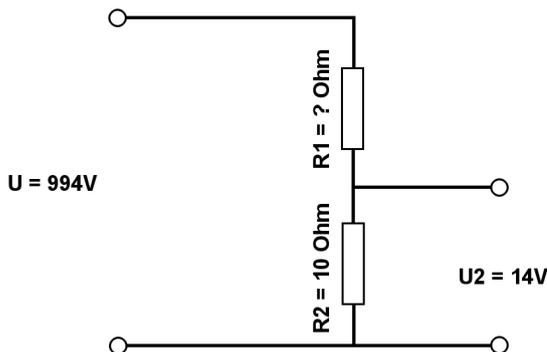
Berechne mit der Spannungsteilerregel die fehlenden Werte.
