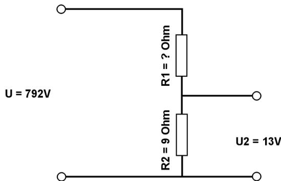
Berechne mit der Spannungsteilerregel die fehlenden Werte.
