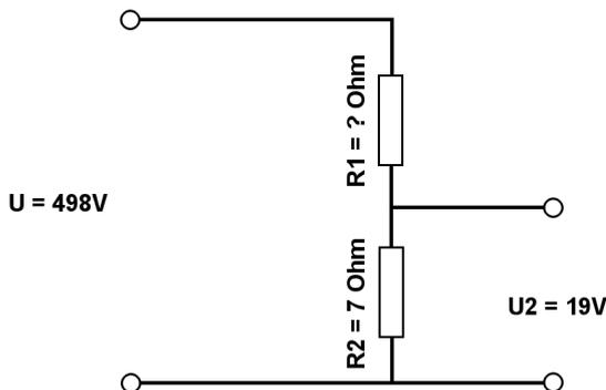
Berechne mit der Spannungsteilerregel die fehlenden Werte.
