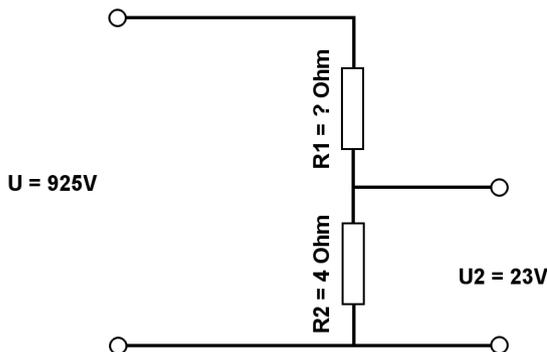
Berechne mit der Spannungsteilerregel die fehlenden Werte.
