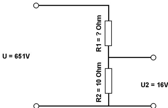
Berechne mit der Spannungsteilerregel die fehlenden Werte.
